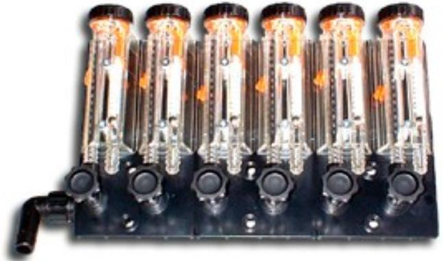
Eine einstellbare Schiebemarkierung in Form eines Pfeiles zeigt nach einer Unterbrechung den Sollwert an. Leichte Reinigung. Durch Abschrauben nur eines Deckels, können die Meßgehäuse mittels beigelieferter Bürste einfach gereinigt werden.
