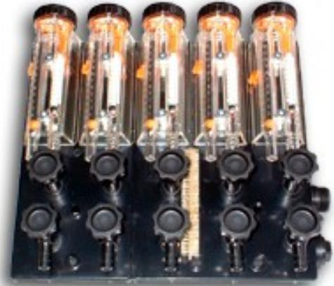
Eine einstellbare Schiebemarkierung in Form eines Pfeiles zeigt nach einer Unterbrechung den Sollwert an. Leichte Reinigung. Durch Abschrauben nur eines Deckels, können die Meßgehäuse mittels beigelieferter Bürste einfach gereinigt werden.
