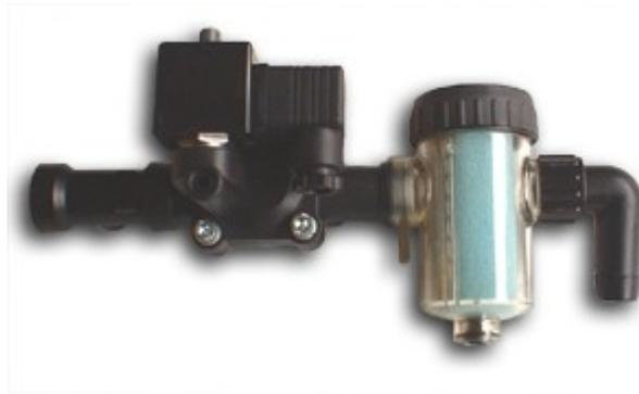
Sofortiger Kühlwasserstop, oder kurzfristiger Wasserzulauf ohne Verstellen der Ventile. Durch das Magnetventil wird bei Störungen oder Stillstand der Maschinen ein auskühlen der Spritzformen oder ein überhitzen von Schweißzangen, Trafo, o.ä. verhindert. Die Magnetventile können wahlweise mit 24 Volt Gleichstrom oder 220 Wechselstrom geliefert werden. Ein Filter ist unbedingt erforderlich. Vorteilhaft ist die Kombination von Druckabfallmeldern und Magnetventil.
